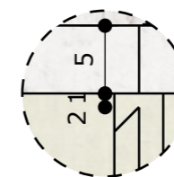
2 DETALHE PUXADOR CAVA 45° ESCALA:1/05
