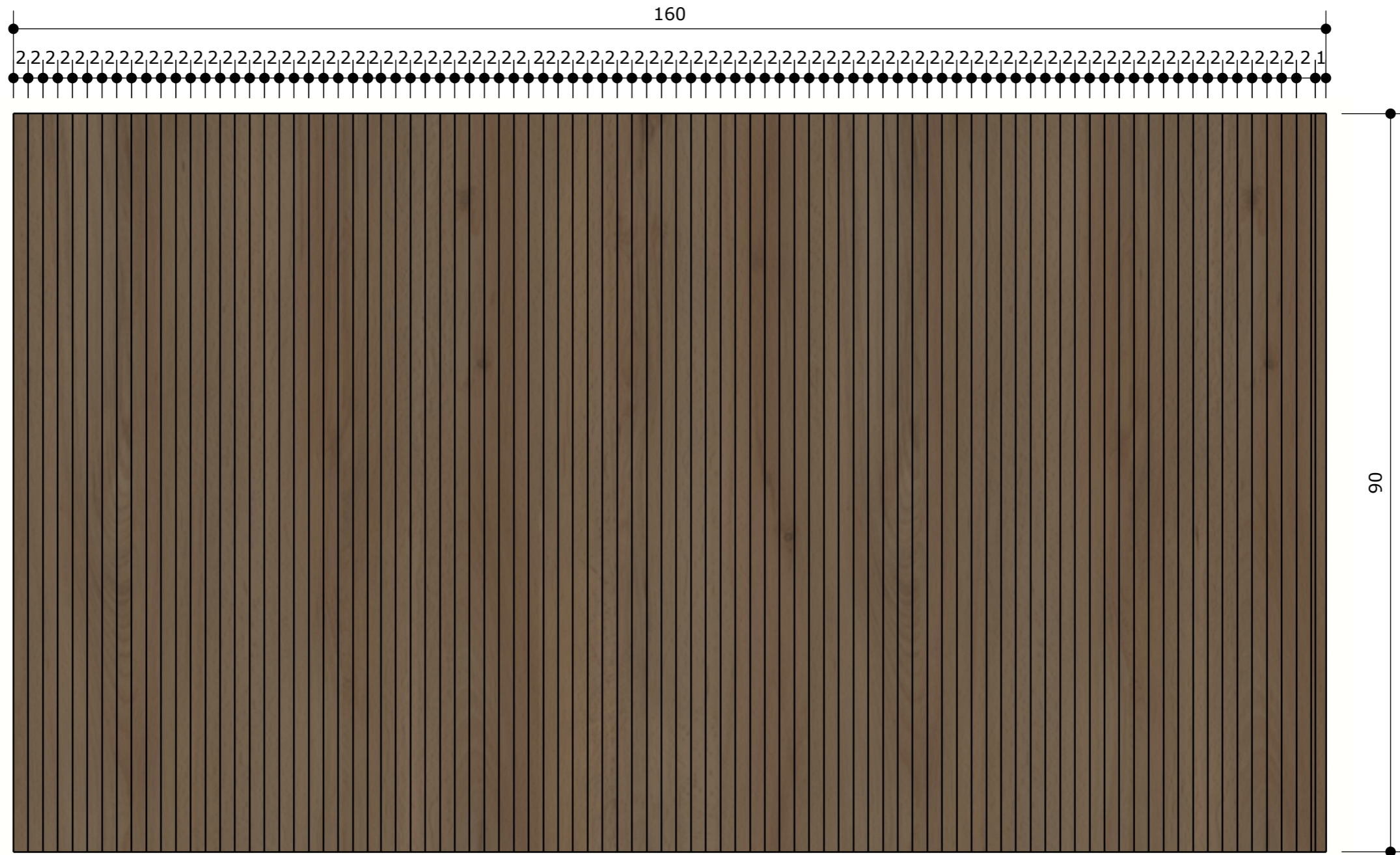
1 COZINHA - MESA - PAINEL RIPADO ESCALA:1/06
