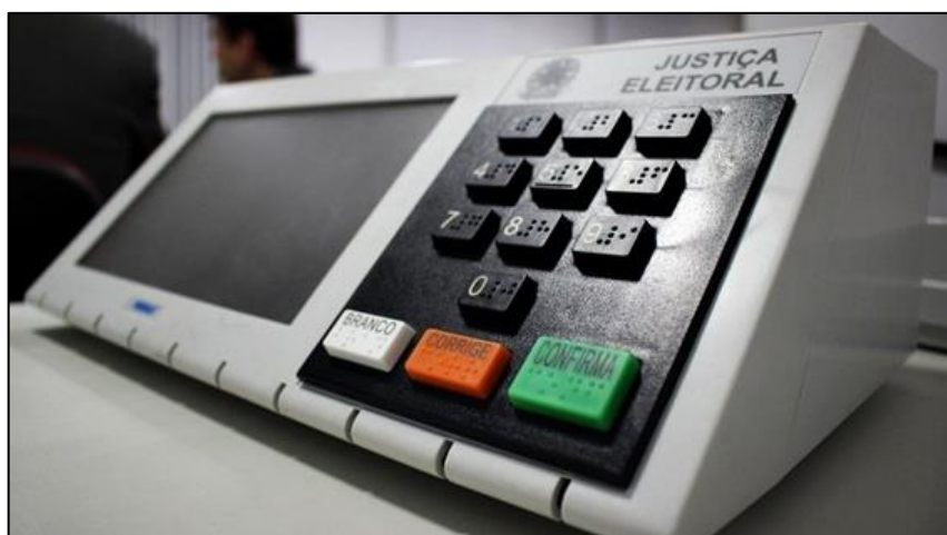
Figura 9 - Urna eletrônica criada para a realização de votações
