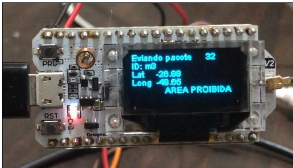
Figura 22– LED de notificação ativo e a mensagem de alerta na tela
