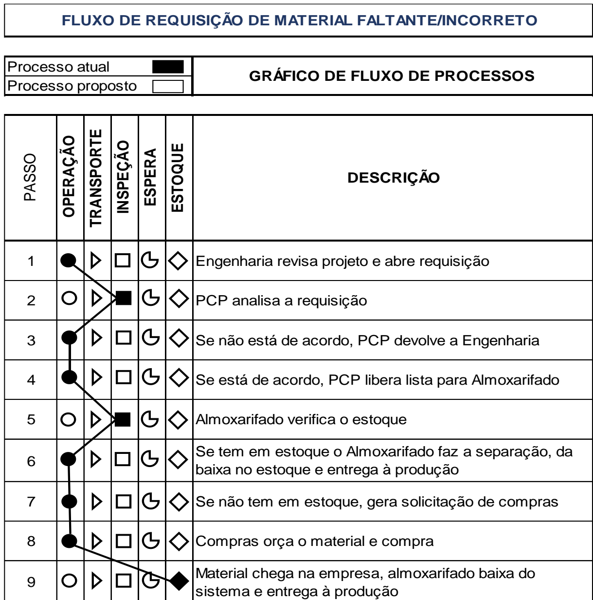
Quadro 2 – Diagrama do Processo de Requisição de Material na Erzeg
