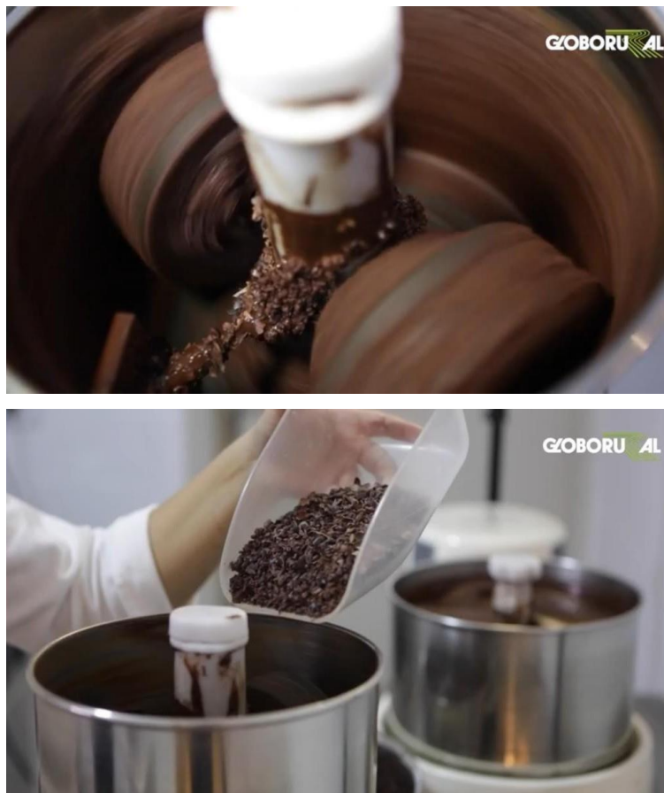
Quadro 3. Mélanger em funcionamento
