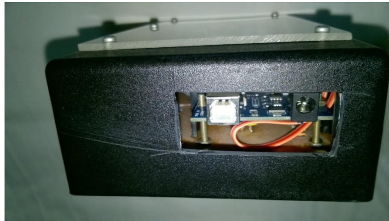
Figura 18 - Entrada de alimentação e porta USB para atualização do firmware
