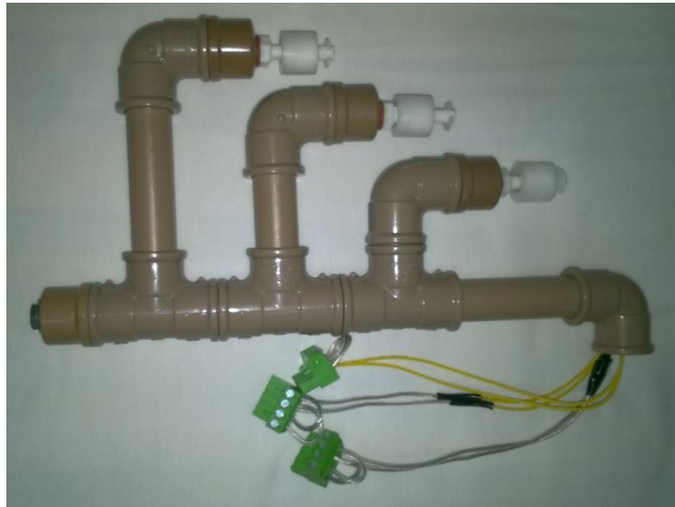
Figura 12 – Régua com sensores de nível de água
