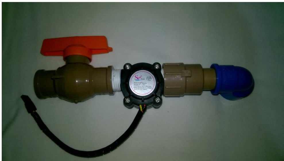
Figura 13 – Sensor de vazão
