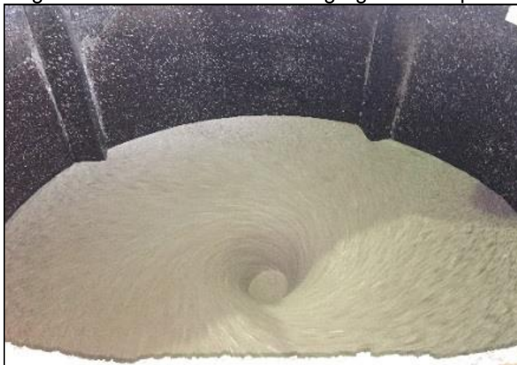
Figura 1 - Parte interna do desagregador de aparas
